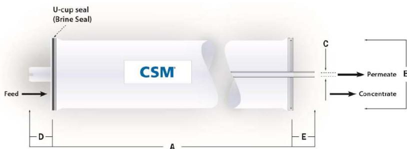
1. Каждый мембранный элемент поставляется в комплекте с одним уплотнительным кольцом линии концентрата, одним пермеатным адаптером и четырьмя прокладками типа O-ring.
